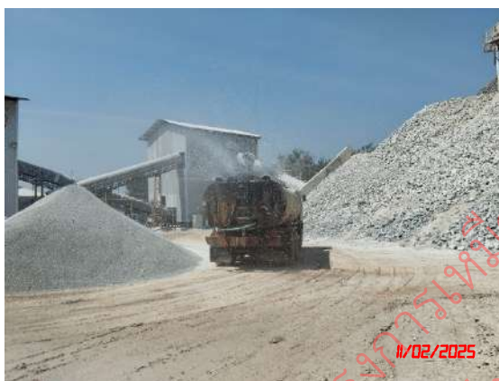
รูปที่ 9 การฉีดพรมน้ำบริเวณเส้นทางขนส่งแร่
